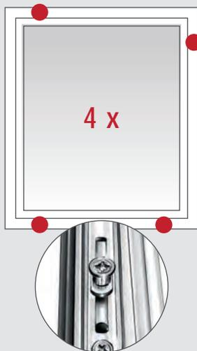
Hier klinken sich 4 Pilzkopf-Verriegelungen aus Stahl in massive Stahlschließbleche ein und verbinden sich zu einem soliden Komplex.
