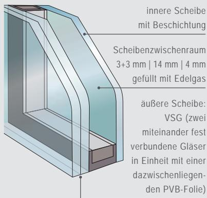
Beim Verbund-Sicherheitsglas VSG werden zwei Glasscheiben mittels einer reißfesten, hochzähelastischen Polyvinylbutyral-Folie zu einer unlösbaren Einheit verschmolzen. Selbst wenn das Glas bei hoher Krafteinwirkung brechen sollte, zerfällt das VSG nicht in einzelne Splitter, sondern bildet weiterhin eine fast undurchdringliche Einheit und reduziert damit die Einbruchs- und Verletzungsgefahr erheblich. VSG bildet einen Basis-Einbruchschutz dar.
