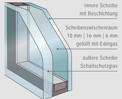
Schallschutzglas ist eine 2-fach-Verglasung Floatglas mit einer außenliegenden Scheibe aus stärkerem Spezialglas. Diese Verglasung liegt mit einem maximalen Schalldämmwert von 37 dB (Schallschutzklasse 3) oder 40 dB (Schallschutzklasse 4) weit über der Schallschutzklasse 2 einer Standardverglasung. Mit einem  $U_G$ -Wert von 1,1  $W/m^2K$  bietet sie, neben der angenehmen Ruhe im Haus, außerdem eine sehr gute Wärmedämmung.
