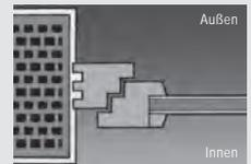
Vorteil des Fenstereinbaus im Außenfalz ist der Sitz fast bündig mit der Fassade und der damit verbundene Gewinn an Optik und Raumvolumen. Eingesetzt werden kann das Fenster aber nur von außen.
