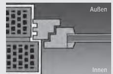
Genauso lässt sich das Fenster in den Innenfalz einsetzen, und zwar ganz bequem von innen. Bei dieser Variante ist der Fensterahmen optimal geschützt und beim späteren Auswechseln bleibt die Außenfassade intakt.
