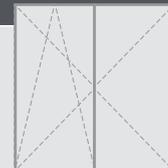
Dreh-Kipp/Dreh-Kipp mit festem Pfosten      Dreh-Kipp/Dreh oder Dreh/Dreh-Kipp
