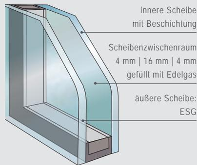
Durch eine spezielle Wärmebehandlung entsteht im Kern des Einscheiben-Sicherheitsglases ESG eine Zugspannung sowie in der Oberfläche eine Druckspannung, was die Stoß- und Schlagfestigkeit des ESG im Vergleich zu normalen Floatgläsern erhöht. Bei großer Gewalteinwirkung zerbröckelt das ESG in viele winzige rundkantige Bruchstücke, statt in scharfe Scherben zu zersplittern. Das senkt die Verletzungsgefahr auf ein Minimum.
