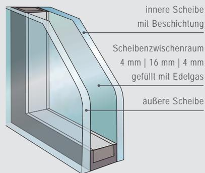
Die Standardverglasung bei EILO-Fenstern mit solider Dämmwirkung; 2-fach- bzw. 3-fach-Verglasung Floatglas mit dazwischenliegendem Abstandhalter aus Aluminium oder Kunststoff („warme Kante“, besserer Wärmeschutz). Die raumseitige Scheibe ist zum Glaszwischenraum hin mit einer Wärmedämmbeschichtung bedampft, der Scheibenzwischenraum mit speziellem Edelgas gefüllt, was den Wärmedämmwert effektiv steigert.
