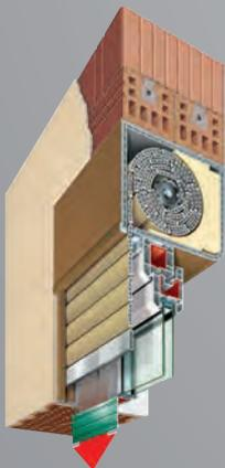
Im Mauerwerk eingesetzt mit Dekor und integriertem Insektenschutz
