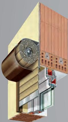
Runde Bauform auf Mauerwerk aufgesetzt
