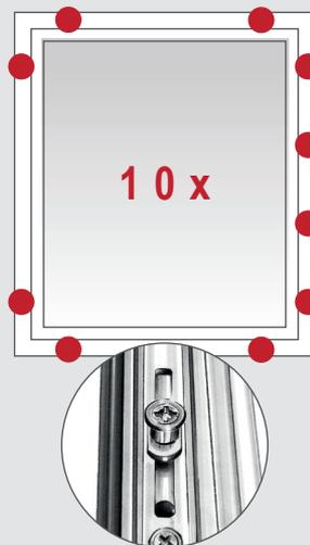
Hier klinken sich je nach Elementgröße 6 bis 10 Pilzkopf-Verriegelungen aus Stahl in massive Stahlschließbleche ein und verbinden sich zu einem soliden Komplex. Für noch mehr Sicherheit im privaten Bereich empfiehlt sich zusätzlich der Einsatz von Verbundsicherheitsglas.
