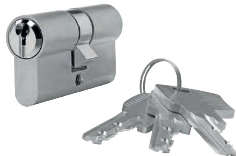
PROFI-Profilzylinder 30/35 * mit Not- und Gefahrenfunktion, beidseitig sperrbar, inklusive 3 Schlüssel
